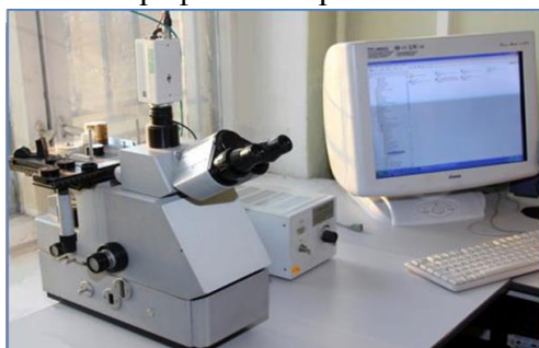
Зураг 4. Компьютерийн дүрс боловсруулах систем бүхий металлографийн микроскоп
